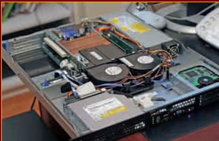
▲ L'interno di un server Dell PowerEdge 850 utilizzato come Web server.
